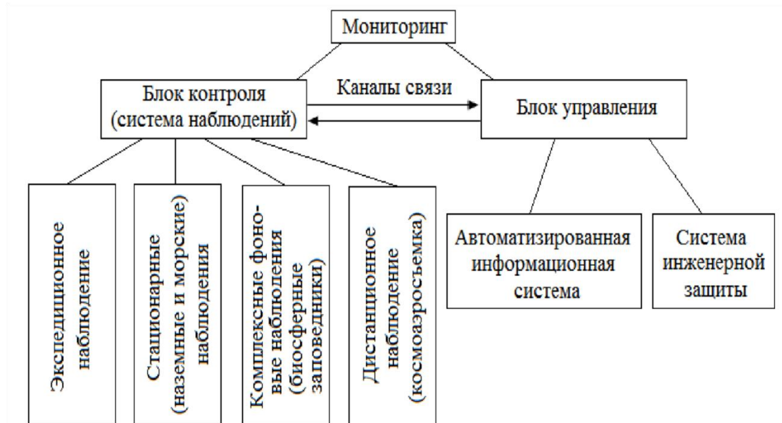
Рис. 1. Структурная схема мониторинга (по В. К. Епишину, В. Т. Трофимову, 1985)
