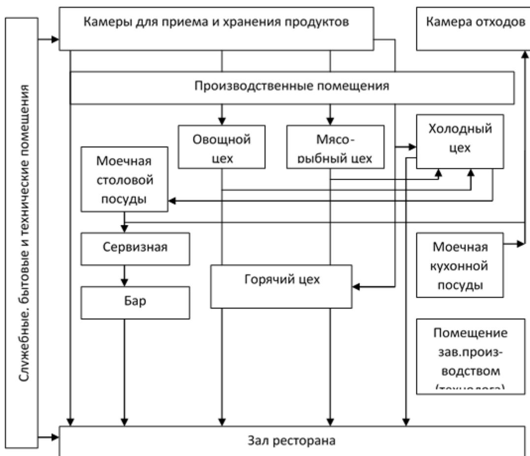
**Примерная схема технологического процесса
